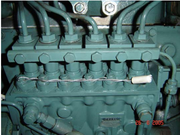
figuur 18: motor met zegel
